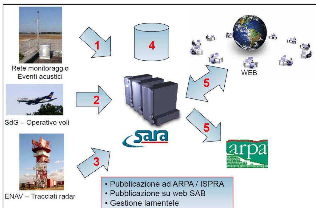
**Img. 8.4 – Schema di funzionamento del sistema di monitoraggio del rumore aeroportuale**
